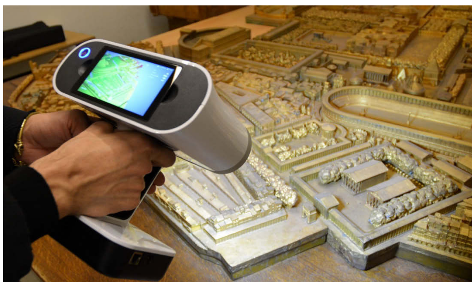
Figure 5 : Modélisation du plan-relief au scanner à lumière pulsée.
