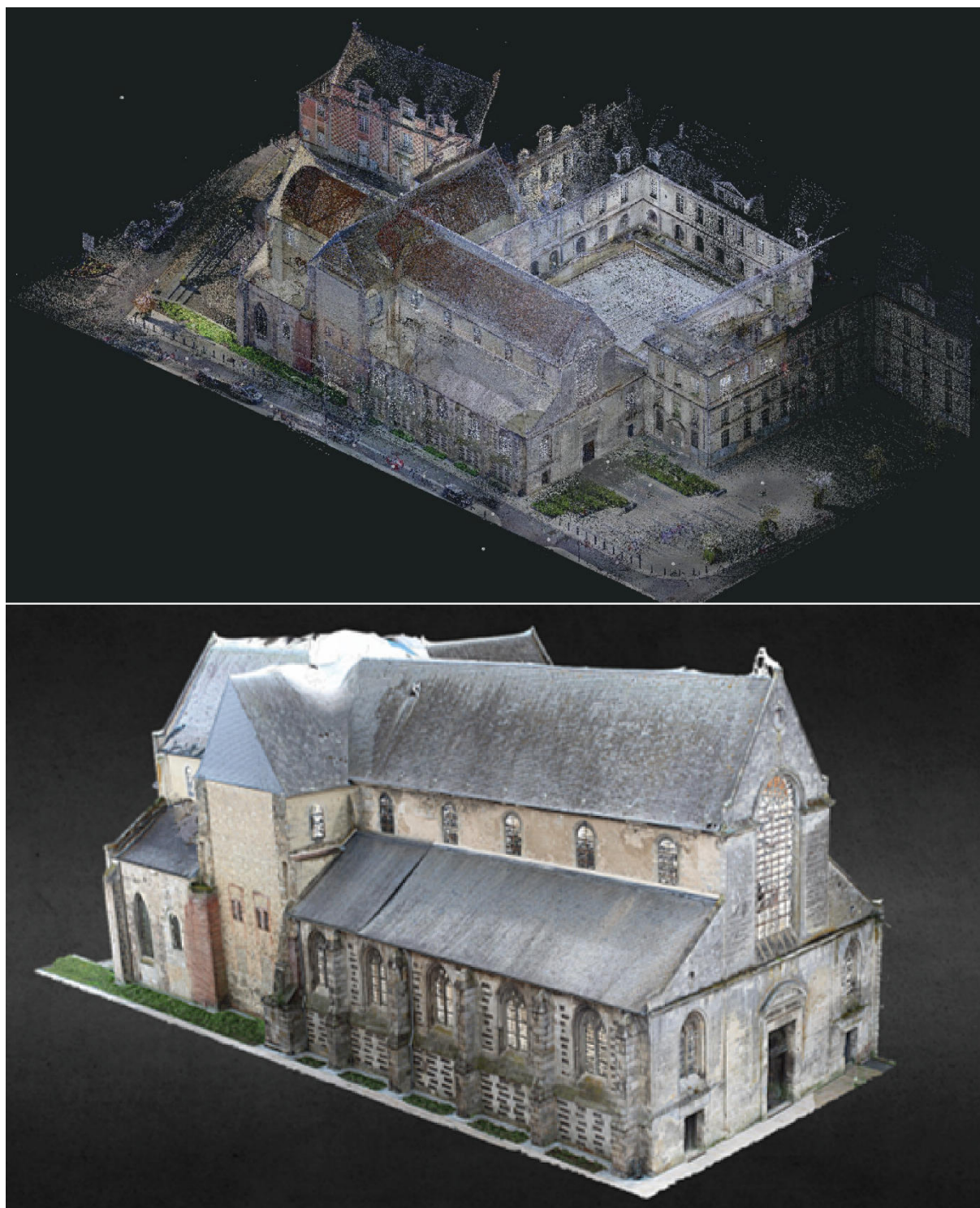
Figure 1 : Numérisation 3D de l'abbatiale, nuage de points et modèle 3D texturé (S. Delamare)
